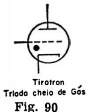
Na Fig. 90 temos as válvulas a gás (Tiratrões), que possuem larga aplicação nos equipamentos industriais como retificadoras, reguladoras de tensão, disparo de reles, etc.
