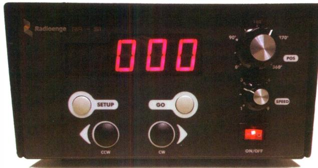
O RA-S1 substitui completamente os controladores desses rotores, e moderniza a estação em que ele será instalado além de facilitar a visualização precisa do ângulo em que a antena está apontada devido ao seu display digital.
