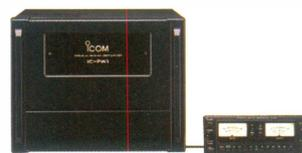
**IC-PW1 Amplificador 1kW**
