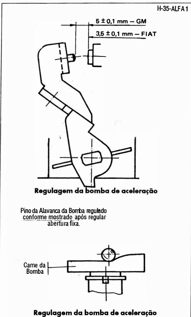
Pino da Alavanca da Bomba regulado conforme mostrado após regular abertura fixa.
